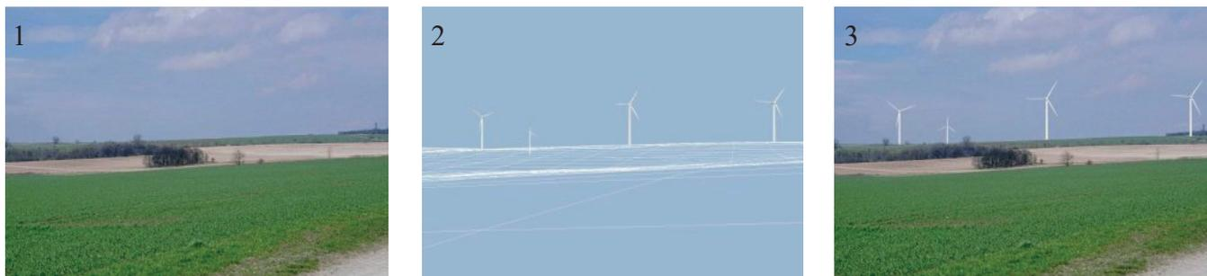
Principe des photomontages: création d'une image (3) par superposition d'une photographie (1) et des éoliennes (2)
